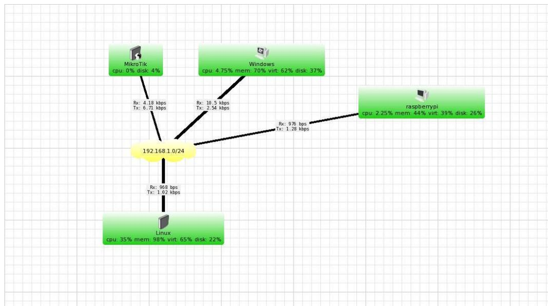
Dari gambar diatas merupakan topologi yang digunakan untuk monitoring jaringan dengan menggunakan aplikasi open source the dude, mikrotik menggunakan ip 192.168.1.1 , windows menggunakan ip 192.168.1.2, linux menggunakan ip 192.168.1.3, dan raspberry pi menggunakan ip 192.168.1.4.
