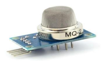
Sensor MQ-2 merupakan sensor yang memiliki sensitifitas yang tinggi. Sensor ini dapat mendeteksi adanya kebocoran gas untuk dirumah ataupun industry. Sensor ini dapat mendeteksi LPG, i-butane, propane, methane, alcohol, Hydrogen, smoke.
