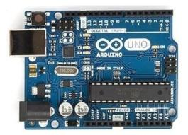
Arduino uno adalah sebuah mikrokontroler yang digunakan untuk membuat alat elektronika karena mudah diaplikasikan dan harganya relative murah.
