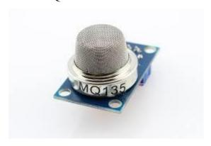
Sensor MQ-135 adalah sensor yang dapat mendeteksi gas amonia, bensol, alkohol, serta gas berbahaya lainnya. Sensor ini cocok digunakan pada proses penentuan kualitas udara (*air quality control*).
