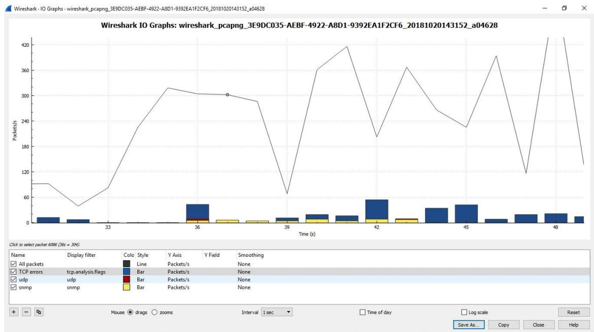
Gambar diatas adalah grafik dari traffic paket protokol SNMP, udp, TCP errors, dan semua paket lainnya yang ditampilkan melalui Wireshark I/O Grafik. Traffic SNMP ditunjukkan dengan bar berwarna kuning, semua paket ditandai dengan grafik line berwarna hitam, udp ditandai dengan bar berwarna merah, dan TCP ditandai dengan bar berwarna hijau biru.
