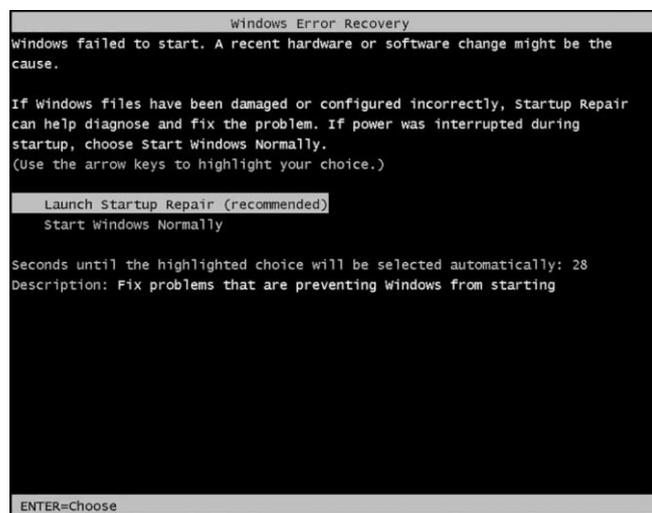
3. Pada pilihan seperti gambar diatas pilih **Launch Startup Repair**, dan akan menampilkan proses *startup repair* seperti contoh gambar dibawah :
