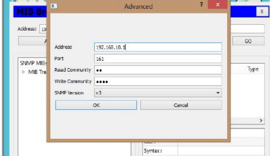
Test SNMP pada router 1
