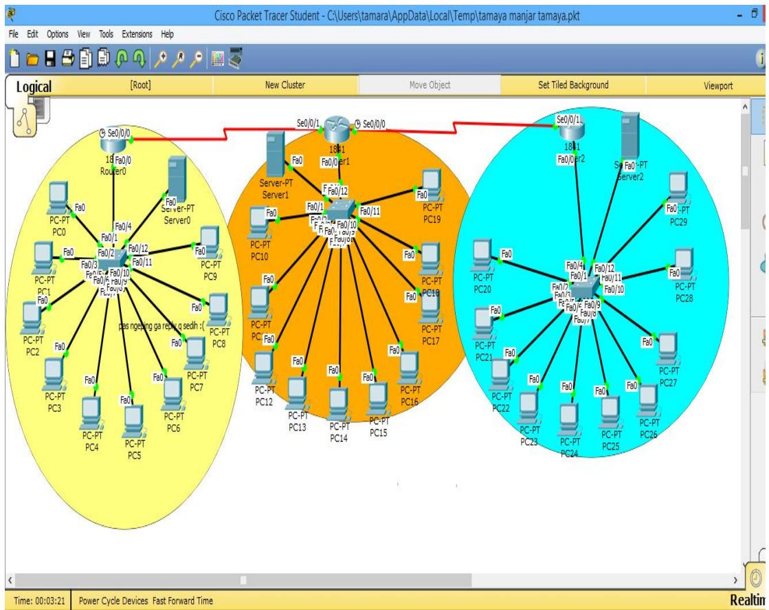
Topologi network yang dibuat pada routing ini menggunakan 3 router, 3 server,dan 30 PC
