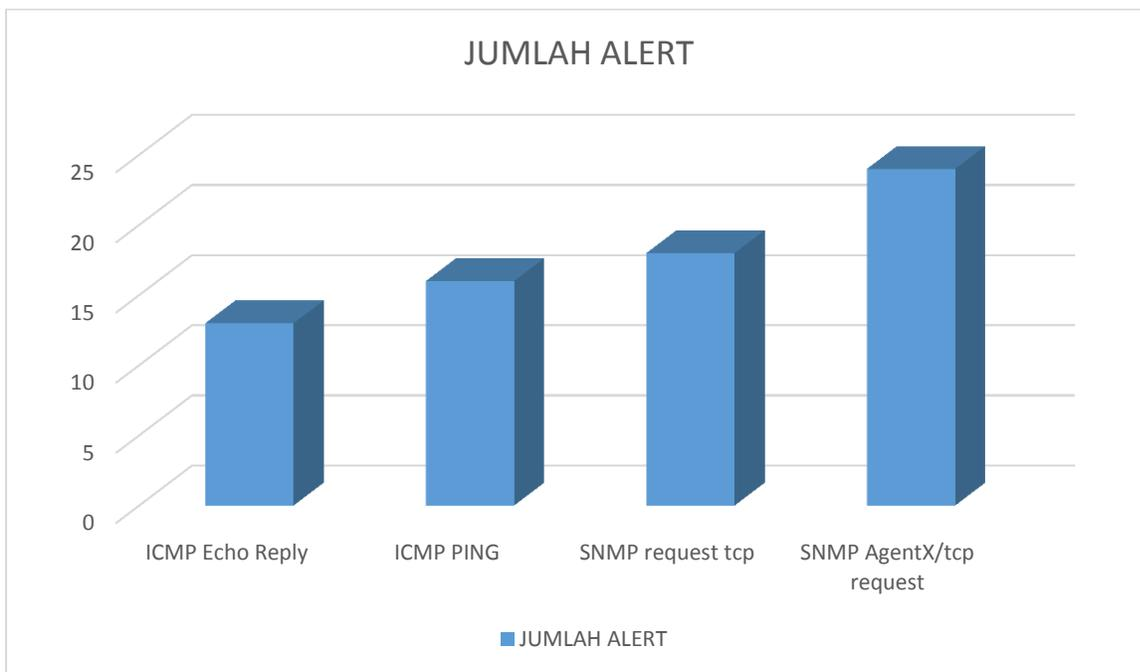
Pada Tampilan hasil Alert diatas terdapat 4 Alert, dari yang tertinggi hingga yang terendah. Yang tertinggi *SNMP AgentX/tcp request* dengan total 24, dan priority nya 2, hingga yang terendah *ICMP Echo Reply* dengan total 13, dan priority nya 3.
